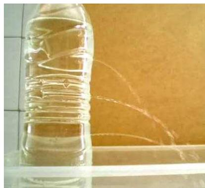
La existencia de dichas fuerzas indica que los líquidos ejercen una presión no solo sobre el fondo del recipiente que los contiene, también sobre las paredes. A la presión ejercida por los líquidos se le denomina **presión hidrostática**.
