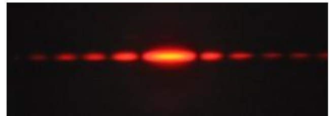
Figura de difracción obtenida haciendo incidir un punto de láser rojo sobre una rendija estrecha.
