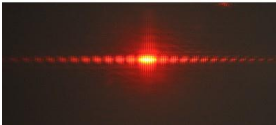
Difracción obtenida haciendo incidir un punto de láser sobre una doble rendija
