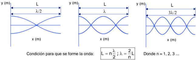
Ahora el primer modo de vibración (modo fundamental o primer armónico) tiene un nodo (en el centro), el segundo armónico dos...etc. La flauta dulce produce este tipo de ondas.
