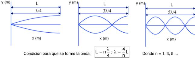
El primer modo de vibración (modo fundamental o primer armónico) se obtiene para n=1
