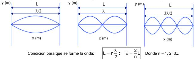
El primer modo de vibración se obtiene para n = 1 y se denomina *modo fundamental o primer armónico*.
